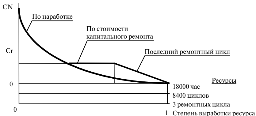
Рис. 7.3.2. Пример обесценения авиадвигателя вследствие неустранимого физического износа
